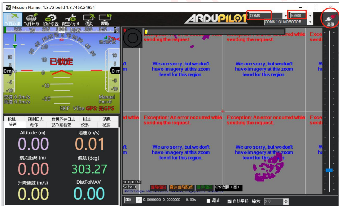
图 3.2 Mission Planner 地面站连接步骤
